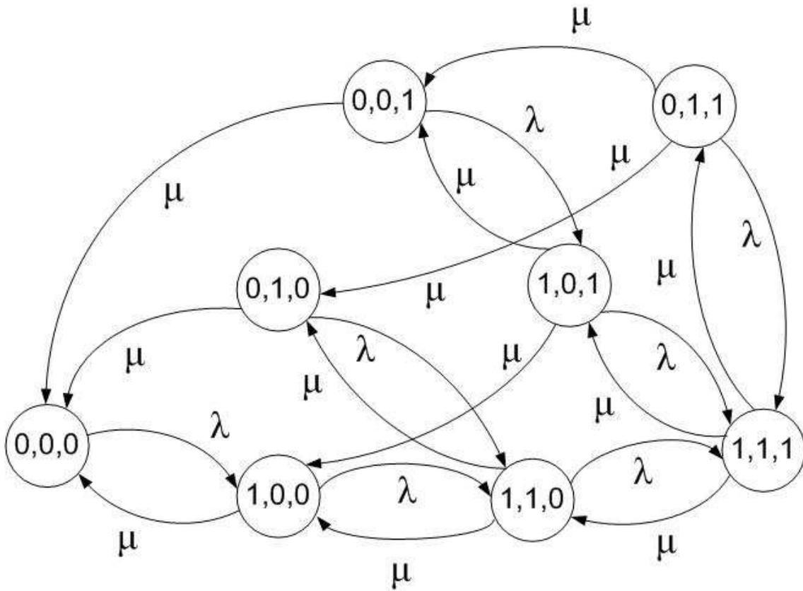
2) Per impostare il sistema che consente di determinare le probabilità stazionarie associate ai diversi stati, si operano i 7 tagli riportati nella figura sottostante
