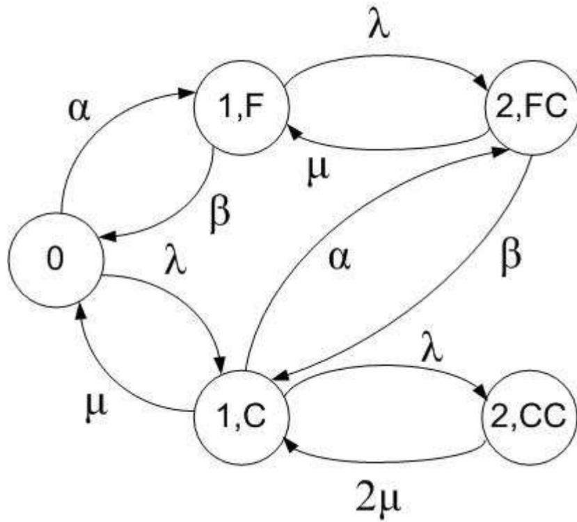
Il sistema che consente di determinare le probabilità stazionarie associate ai diversi stati può essere determinato imponendo la condizione di normalizzazione ed operando ad esempio i 4 tagli riportati nella figura sottostante.
